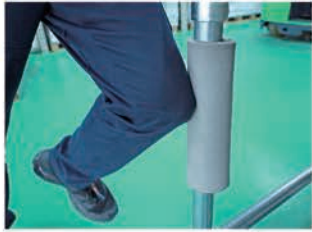
作業台の脚に巻いて 緩衝に使用
